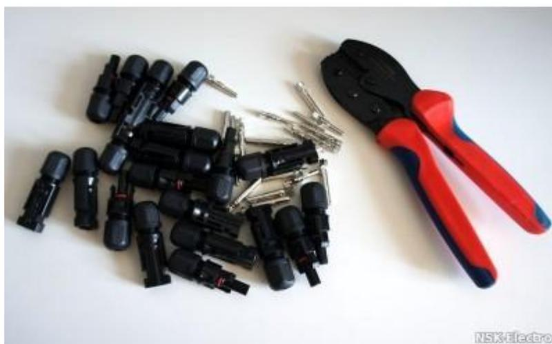
Для быстрой коммутации солнечных батарей используют специальные герметичные коннекторы MC4. Как правило солнечные панели мощностью от 100 Вт с завода комплектуются проводами с именно такими разъемами.
