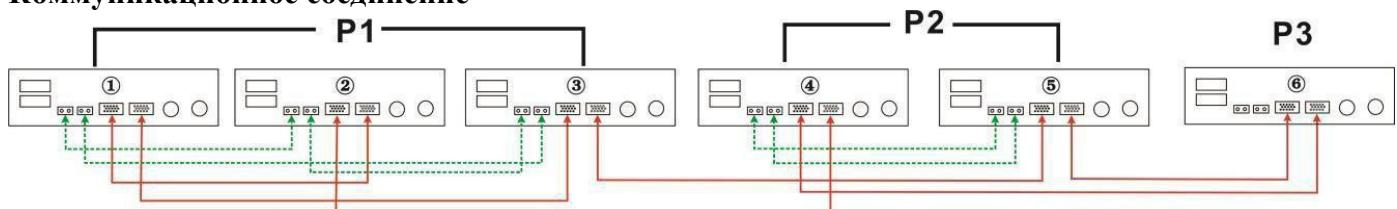
Четыре инвертора в одной фазе, по одному инвертору – в двух других фазах:
