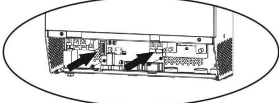
**Шаг 6:** Переподключите 2-контактные и 14-контактные кабели.
