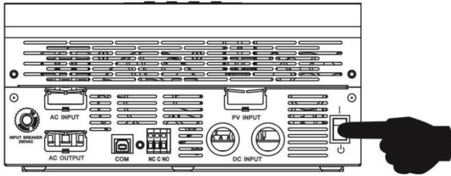
После установки устройства и подключения аккумулятора, нажмите выключатель питания On/Off, чтобы включить устройство. Кнопка включения находится на нижней части инвертора.
