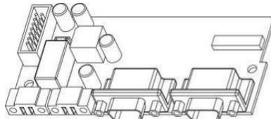
Плата параллельного подключения
