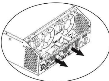
**Шаг 3:** Открутите 2 винта (см. ниже) и отсоедините 2-контактные и 14-контактные кабели.
