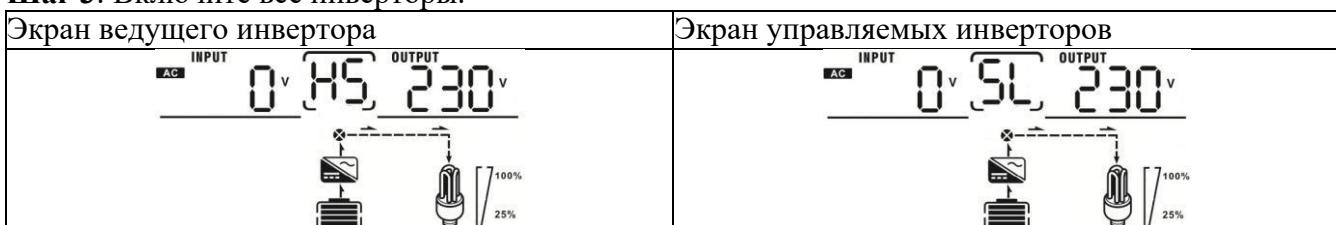
**Замечание:** Определение ведущего и управляемых инверторов происходит автоматически.
