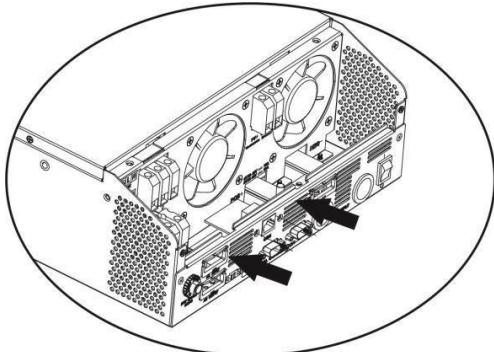
**Шаг 8:** Установите крышку защиты кабелей на место. Инвертор готов к работе в параллельном режиме.
