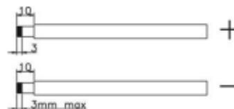
2. Используйте втулочный наконечник для обжима положительного и отрицательного проводов с помощью специального обжимного инструмента.
