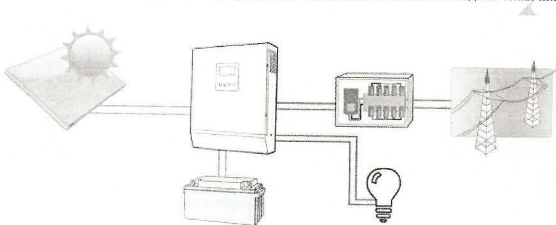
Рисунок 1 – Типичная схема подключения гибридного солнечного инвертора
