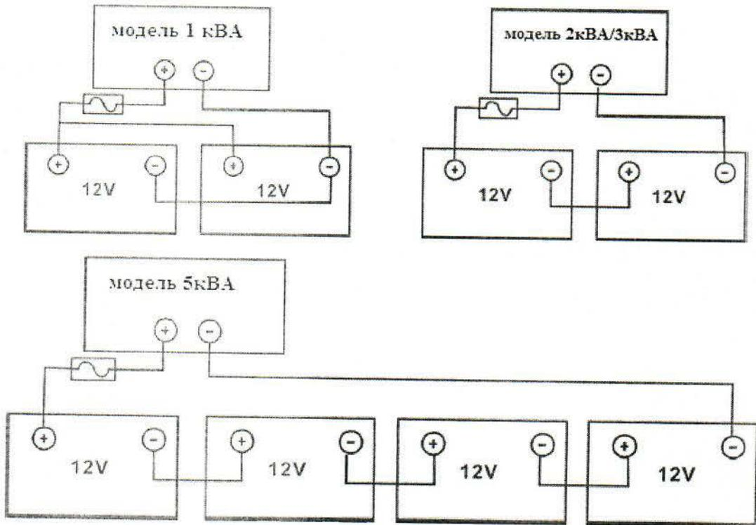
5. Заведите провода от аккумулятора, предварительно обжатые втулочным наконечником в разъем инвертора, обозначенный соответствующей надписью и затяните болты с крутящим моментом 2 Нм по часовой стрелке. Убедитесь, что полярность соединения соблюдена, а также все соединения имеют плотный контакт с местами установки проводов.
