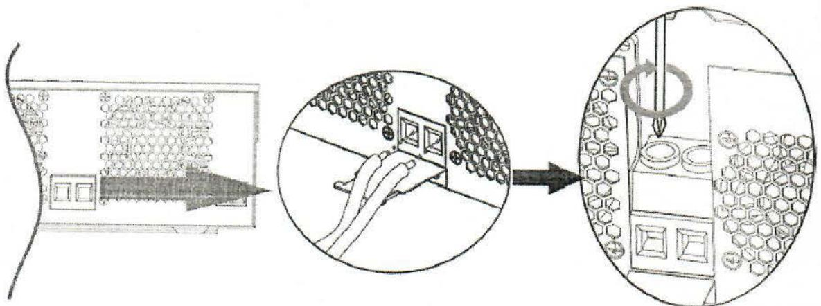
6. Чтобы надежно зафиксировать провода, используйте зажимной хомут для кабеля, обжав кабель с прижимной пластиной, прикрученной заранее.
