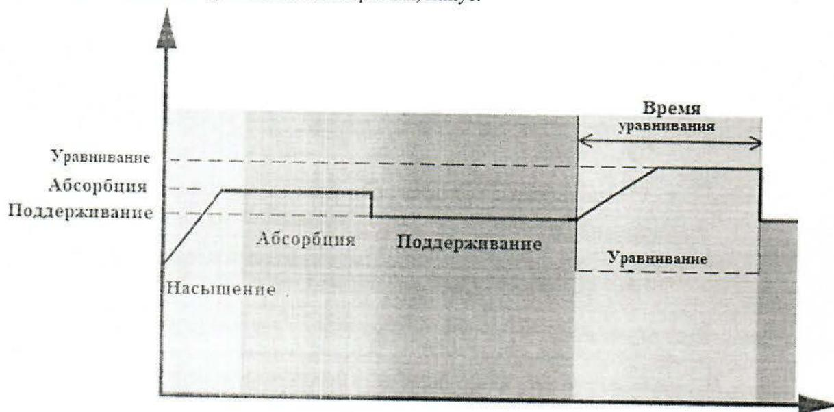
Однако бывает так, что при уравнивании за время, указанное в настройках, напряжение аккумулятора не поднялось до напряжения уравнивания аккумулятора. Контроллер заряда сам продлит время уравнивания, пока аккумулятор не достигнет заданного напряжения. Если напряжение аккумулятора все равно осталось ниже, чем напряжение уравнивания и режим уравнивания остановится, контроллер заряда перейдет в режим поддерживающего заряда.
