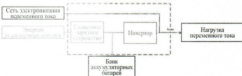
Если выключатель питания ON/OFF (ВКЛ/ВЫКЛ) установлен в положение ON (ВКЛ), устройство подаст питание на нагрузку. Если выключатель питания ON/OFF установлен в положение OFF (ВЫКЛ), устройство не будет подавать питание на нагрузку. В аккумуляторную батарею ток зарядки не подается.
