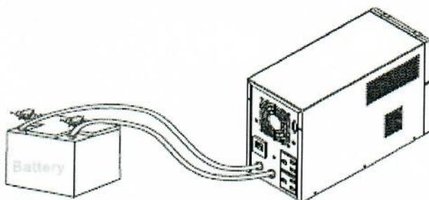
2) Параллельное присоединение нескольких аккумуляторных батарей.
