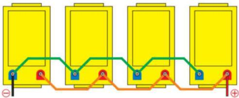
**ПРЕДУПРЕЖДЕНИЕ:** При последовательном или параллельном подключении батареи измерьте напряжение батареи мультиметром. Напряжение батареи должно быть одинаковым или разница в напряжении должна составлять менее 0,2 В (это нормально, если при параллельном соединении возникает небольшая искра). Запрещено подключать батареи последовательно/параллельно, если напряжение батареи превышает этот диапазон.
