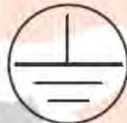
Минимальный размер поперечного сечения медного провода заземления составляет 8 AWG (10 мм<sup>2</sup>).
